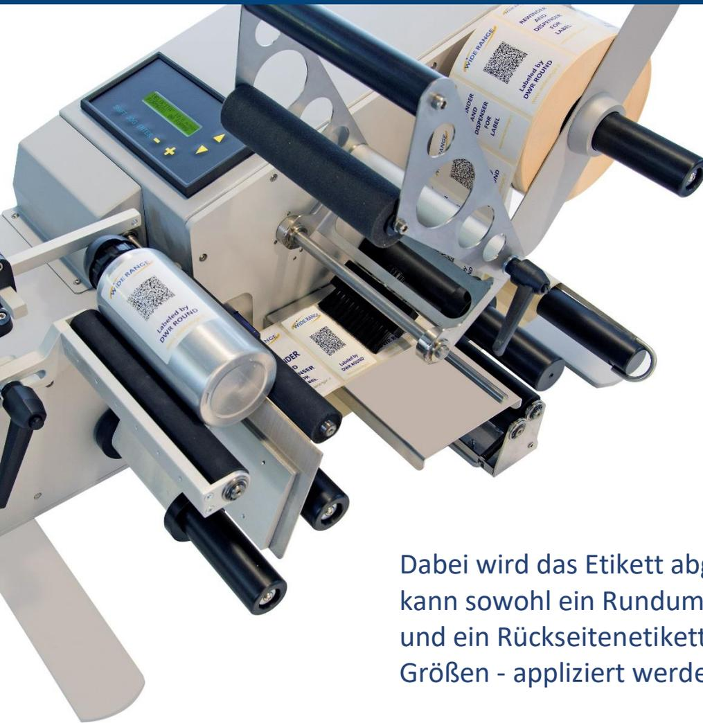
Der **JR-2000** ist für die halbautomatische Etikettierung von runden Produkten entwickelt worden. Das Gerät ist äußerst robust und sehr flexibel. Nach Einlegen eines Produktes und Betätigung der Anrolleinheit wird dieses automatisch in Rotation versetzt.
