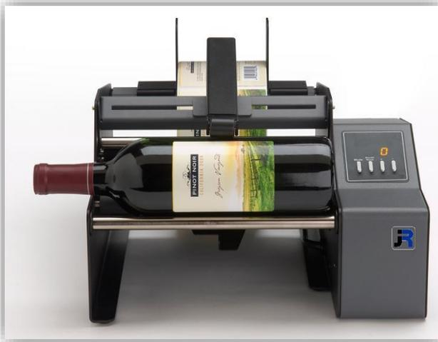
Der Tischetikettierer JR-100 für selbstklebende Etiketten ermöglichen ein fast vollautomatisches Etikettieren von zylindrischen und vielen kegelförmigen Behältern, wie z.B. Flaschen, Dosen, Gläsern oder Tuben.
