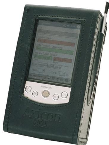
Die Axicon 9025 ist eine mobile Anzeige-Einheit zur ISO/CEN/ANSI Barcodeprüfung. Verwendbar mit: Axicon 6000, 6500 oder 7000 Serie Prüfgeräten.
