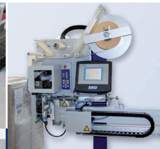
Der Paletten-Etikettierautomat A128 druckt und appliziert Etiketten bis zum Format DIN A5 auf die Stirn- und/oder Seitenfläche einer beladenen Palette oder anderer Gebinde und ermöglicht damit eine GS1-konforme Produktauszeichnung.
