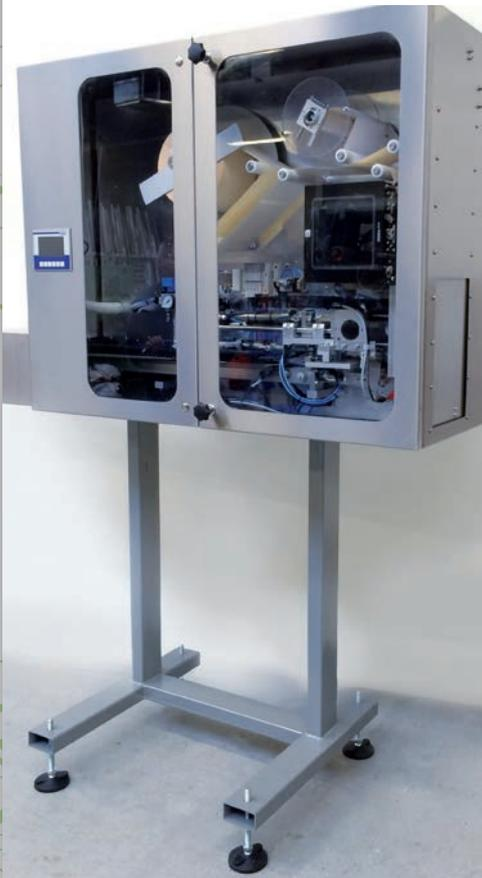
Der **primus** ist ein innovatives Druck-Spende-System, das über verschiedene pneumatische Verfahrachsen bis zu drei Seiten einer Palette auszeichnen kann. Die Etiketten werden unmittelbar vor dem Appliziervorgang mit individuellen Daten bedruckt. Dafür können in den **primus** die Thermotransfer-Druckmodule der Hersteller CAB, Datamax, Novexx, SATO, Valentin und Zebra integriert werden.
