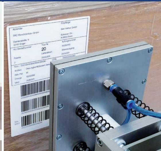
Der Paletten-Etikettierautomat **primus** druckt und appliziert Etiketten bis zum Format DIN A5 auf die Stirn- und/oder Seitenfläche einer beladenen Palette oder anderer Gebinde und ermöglicht damit eine GS1-konforme Versandkennzeichnung.
