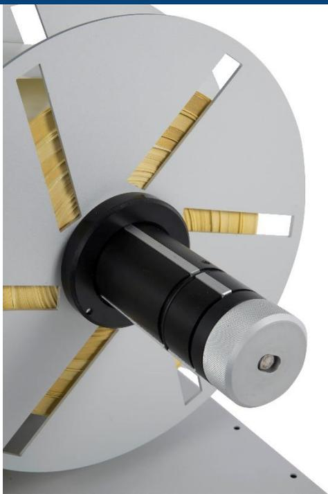
Der Etikettenauf- und Abwickler JR-400-JUMBO ist für die Verarbeitung von Selbstklebeetiketten auf Rolle konzipiert worden. Er ist eine robuste Stahlkonstruktion und kann Großrollen bis zu einem Durchmesser von 400 mm und einer max. Breite von 230 mm auf- bzw. abwickeln. Die Wickelgeschwindigkeit ist pendelarmgesteuert und passt sich automatisch der Druckergeschwindigkeit an. Außen oder Innenwicklung ist einstellbar. Bei Ende stoppt das Gerät automatisch.
