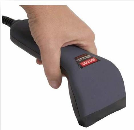
Der **Axicon PC 6015** ist ein Prüfgerät mit CCD-Technologie. Mit dem PC 6015 können Sie Codes in CEN Klasse A prüfen, mit einer Codebreite von bis zu 70 mm. Das Gerät ist einfach zu bedienen und verursacht durch die kontaktlose Prüfung keine Beschädigungen am Prüfgut.
